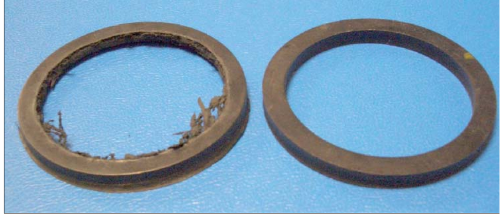
Abb. 2: Schadensbild einer Dichtung.
